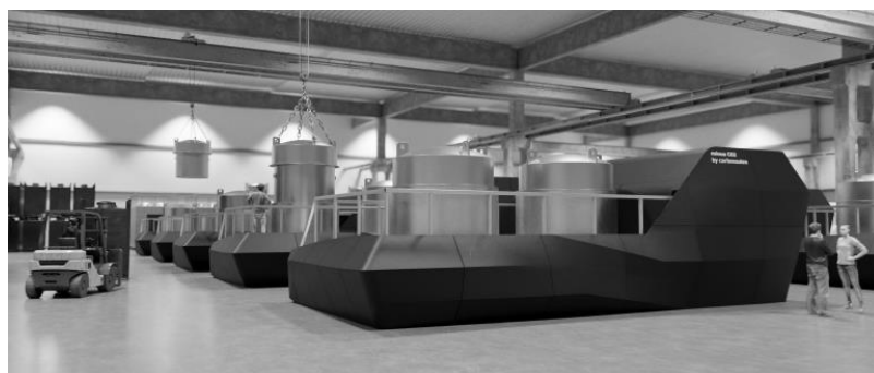
Abb.: Ein Modul besteht aus Wechselretorten, Pilotbrennern, Öfen, einem Wärmespeicher und Bio-Ölsammler.
